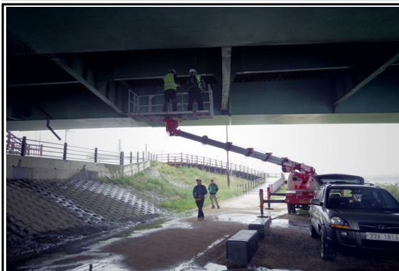
고소차를 이용한 상부비파괴 시험
