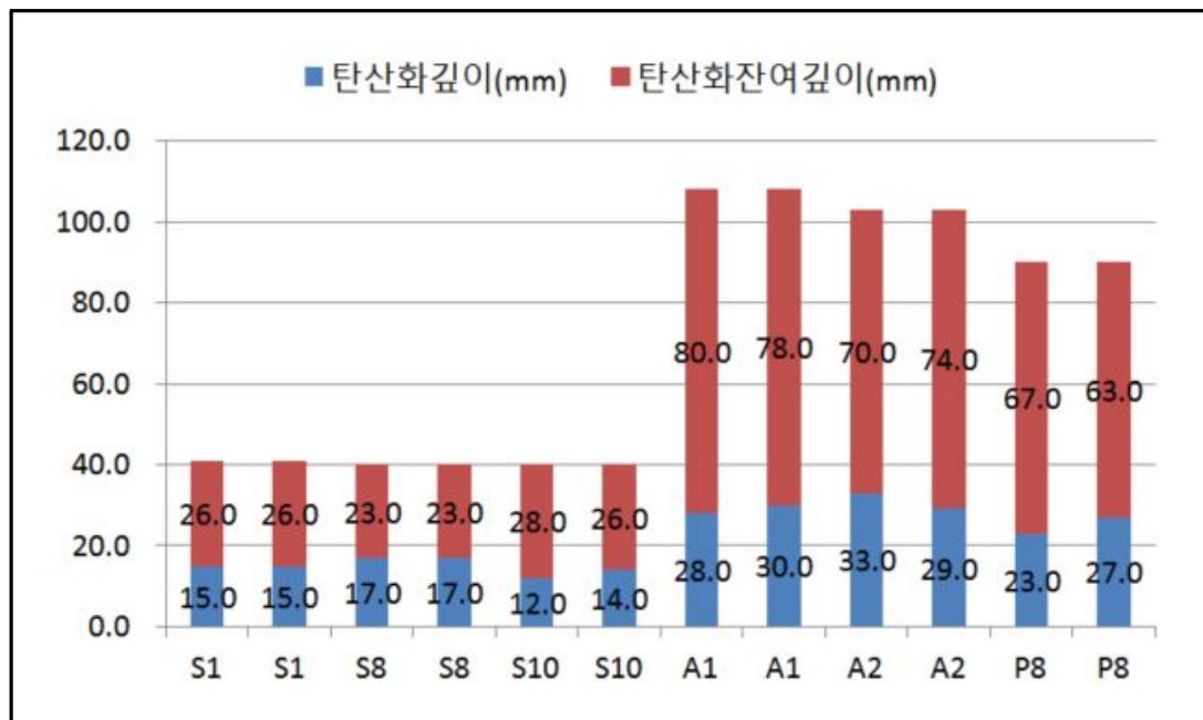
【그림 4.4】 탄산화 진행깊이 및 잔여깊이 측정결과
